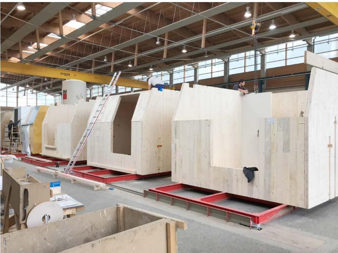
BILD 8: 24.09.2018 - SERIENFERTIGUNG AUF DEM FLIESSBAND IM WERK FA KAUFMANN, KALWANG, AT - MONTAGE RAUMMODUL„ROHBAU“
