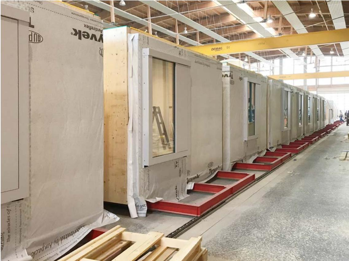
BILD 9: 24.09.2018 - SERIENFERTIGUNG AUF DEM FLIESSBAND IM WERK FA KAUFMANN, KALWANG, AT - MONTAGE FENSTER UND AUSSENDÄMMUNG
