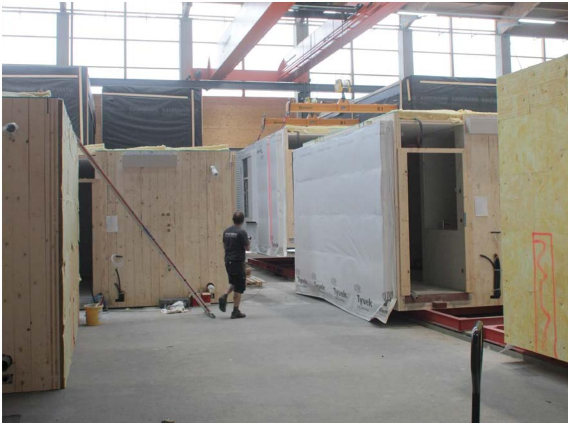
BILD 12: 24.09.2018 - SERIENFERTIGUNG AUF DEM FLIESSBAND IM WERK FA KAUFMANN, KALWANG, AT - LAGERUNG FERTIGER MODULE
