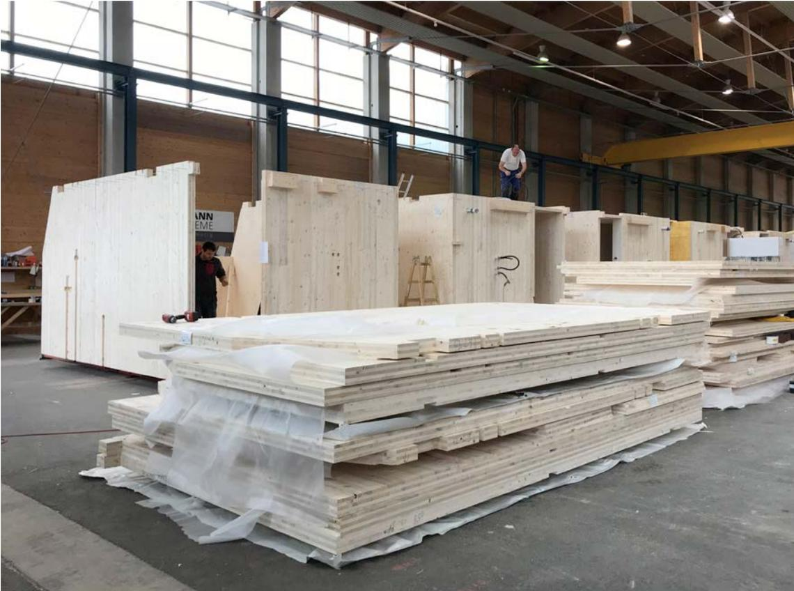
BILD 7: 24.09.2018 - SERIENFERTIGUNG AUF DEM FLIESSBAND IM WERK FA KAUFMANN, KALWANG, AT - MONTAGE RAUMMODUL„ROHBAU“
