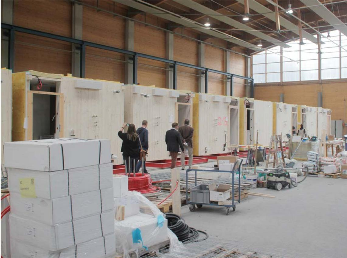
BILD 11: 24.09.2018 - SERIENFERTIGUNG AUF DEM FLIESSBAND IM WERK FA KAUFMANN, KALWANG, AT - MATERIALDISPOSITION AUSBAUGEWERKE
